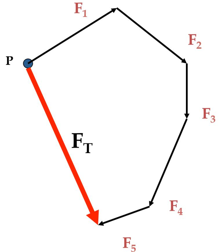
**I due metodi sono equivalenti:** L'intensità della risultante  $F_T$  si determina nel seguente modo:  $F_T = 10 \times 5 = 50$  N, dove 10 cm, per esempio, è la lunghezza del vettore  $F_T$  misurata con una riga.
