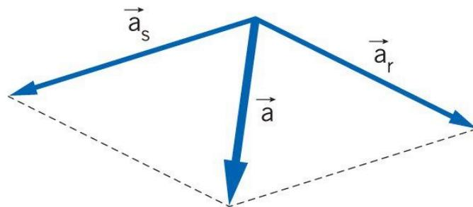
Dato il vettore  $\mathbf{a}$  e due direzioni qualsiasi  $r$  e  $s$ , applicando la regola del parallelogramma al contrario, otteniamo le componenti  $\mathbf{a}_s$  e  $\mathbf{a}_r$  lungo le direzioni prefissate in modo che  $\mathbf{a} = \mathbf{a}_s + \mathbf{a}_r$
