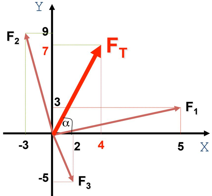
$$F_{Tx} = F_{1x} - F_{2x} + F_{3x} = 5 - 3 + 2 = 4\text{N}$$
